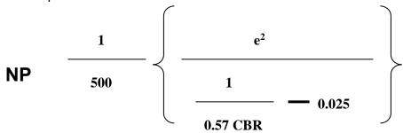
Para la cual **e** representa el espesor en centímetros de la fundición del pavimento.
